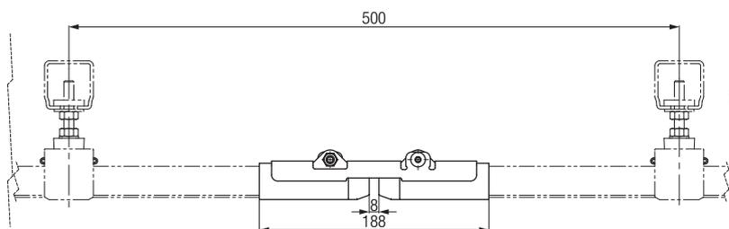
Воздушные разрывы используются для изоляции секций, таких как ремонтные зоны (участки для проведения ремонтных работ на кранах), которые могут быть отключены от подачи общего питания на систему шинопроводов. Для каждой точки разрыва должно быть установлено два воздушных разрыва на достаточном расстоянии друг от друга, чтобы избежать возможного замыкания системы при прохождении тока через токосъёмники.
