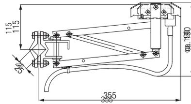
Токосъёмники с параллельными штангами полностью выполнены из металла поставляются в одинарном или сдвоенном виде. Токосъёмники шины заземления РЕ имеют зелёную цветовую отметку и снабжены специальным дефлектором предотвращающим случайное их попадание на фазный шинопровод РН.
