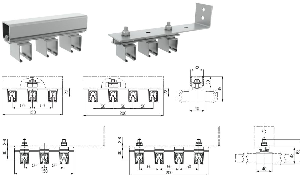
Компактные подвесные держатели для быстрой установки 3-х или 4-х полюсных систем внутри помещений. Варианты крепления: для открытых подвесных кронштейнов или под кронштейны Conductix-Wampfler из С-образного профиля 30x32x2 мм, изготавливаемые из гальванизированной или нержавеющей стали (далее стр.27).
