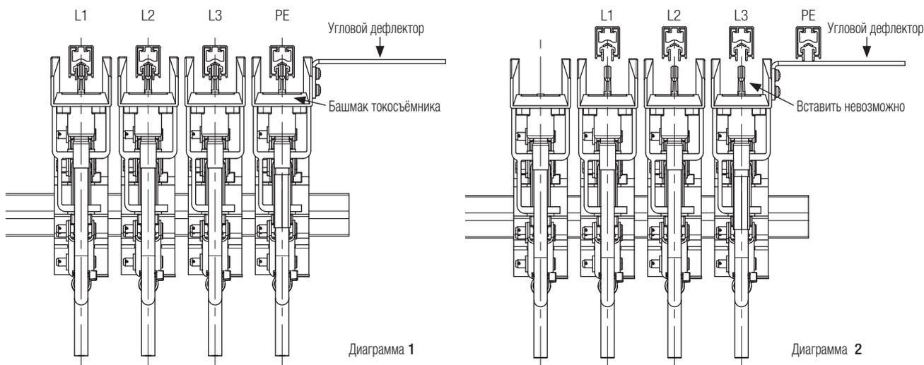
Невозможность попадания токо съёмника PE (заземления) на фазную шину
