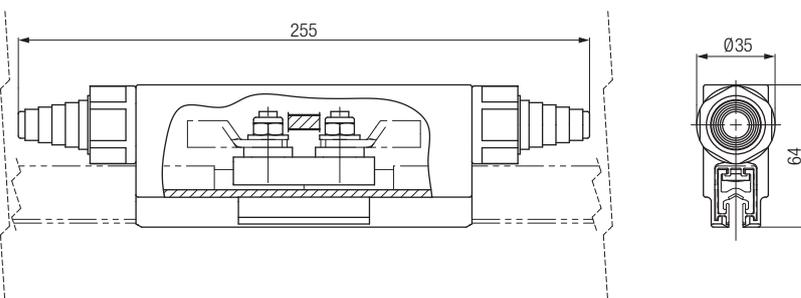
Для подачи питания используется линейный ввод, который может заменять обычные соединители шин. Электрическое соединение осуществляется при помощи болтового соединения и кабельного наконечника (кабель и кабельные наконечники необходимо заказывать отдельно).
