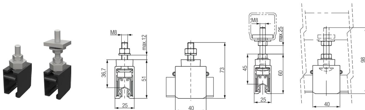
Держатель выполнен в виде вращающегося зажима, который имеет возможность самоустанавливаться. Обладая низким коэффициентом трения, он позволяет скользить шине при температурном расширении. Подвесные держатели разработаны для крепления шестигранными гайками или квадратными гайками для монтажа к кронштейнам (см.монтажные принадлежности).
