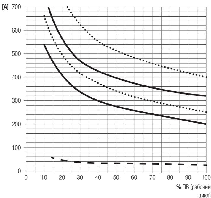
Ток нагрузки проводящих шинопроводов может быть увеличен при более коротких рабочих циклах. Примечание: Сравнивая номинальные токи шинопроводов различных производителей следует учитывать температуру окружающей среды и длительность рабочего цикла! Следует учитывать потребителей со 100% ПВ, такие как освещение, системы кондиционирования воздуха или магнитные захваты. 100% ПВ  $\hat{=} t \geq 10$  мин. (в соответствии со стандартами EN)
