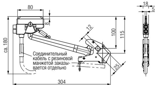
Сдвоенный токоcъёмник для реверсивной установки
