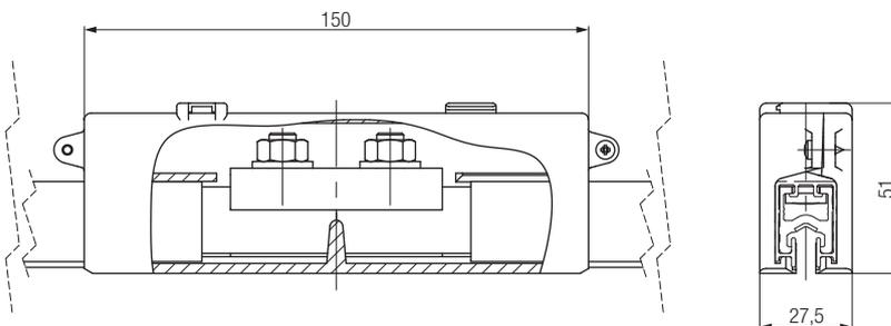
Шинопроводы стыкуются между собой компактным винтовым соединением. При сборке поверхность соединителя должна иметь идеальный металлический контакт. Для лучшего контакта покройте поверхность тонким слоем контактной смазки (артикул для заказа №080021). При зажиме винтов необходимо использовать динамометрический ключ для достижения требуемого момента затяжки.
