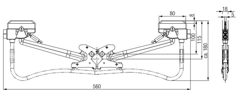
Монтаж натяжных пружин
