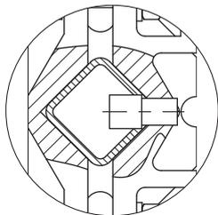
В системах, имеющих пересечения, невозможно перемещение стандартного токо съёмника PE (с угловым дефлектором) через переходные воронки. Поэтому для использования в системах имеющих пересечения кронштейн токо съёмника заземления PE оборудован специальным болтом. Данный болт фиксирует положение защитного токо съёмника PE будучи вставленным в отверстие сделанное в кронштейне.
