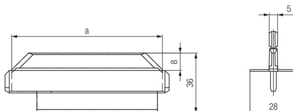
Медно-графитовая щётка защищена пластиковым изолятором так, что случайные прикосновения к токоведущим частям исключены.
